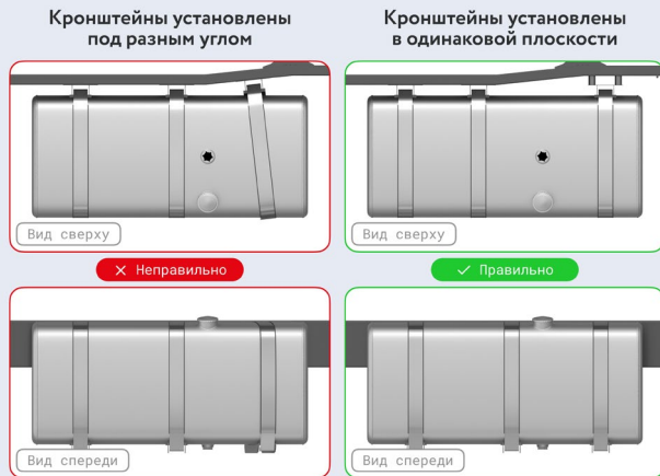
Рис. 2 — Схема установки кронштейнов на топливный бак
