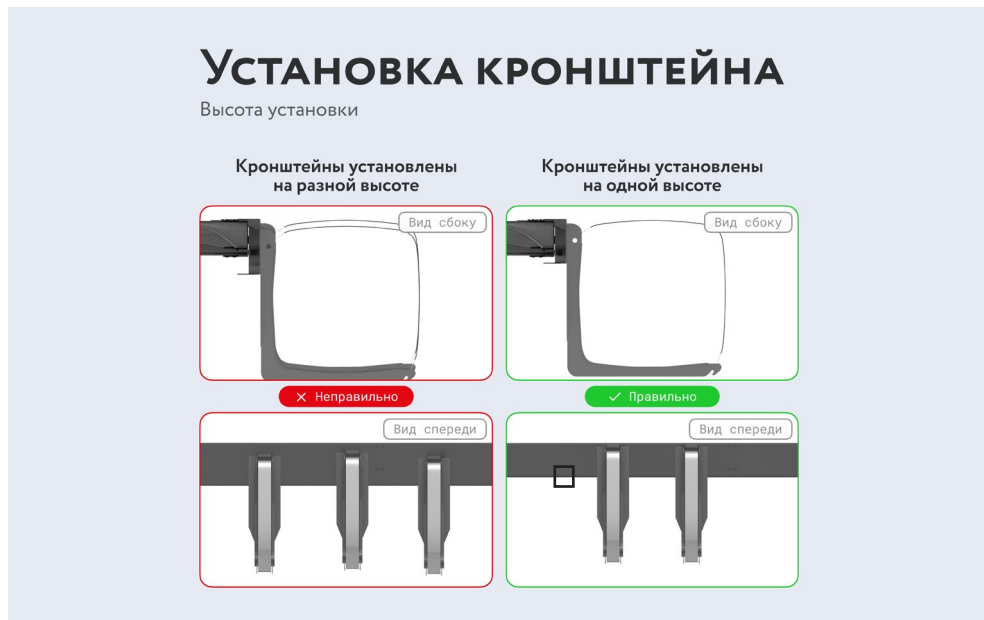
Рис. 1 — Схема установки кронштейнов на автомобиле
